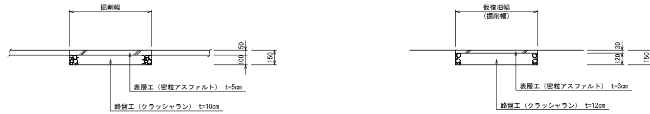
アスファルト舗装 (町道部) (国道歩道部)
