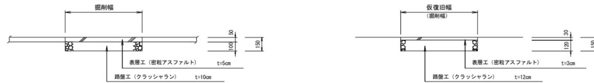
※本復旧は、舗装厚→現況 舗装幅→全幅or半幅とする。
