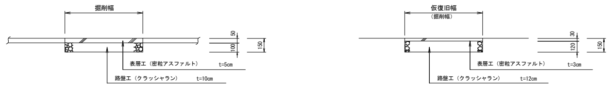
アスファルト舗装 (町道部)
