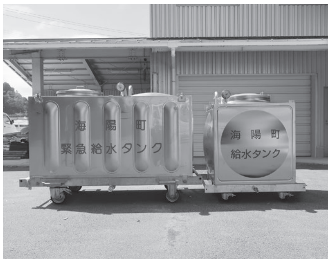
災害時に使用する給水タンク
